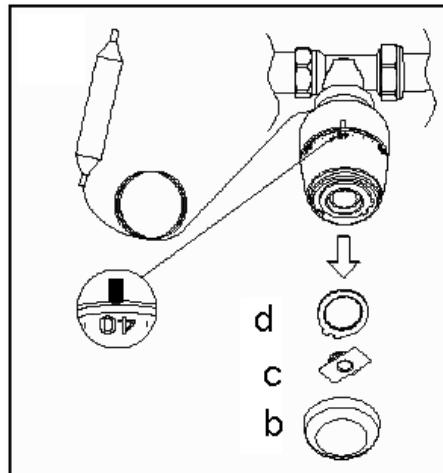
6.2. Для ограничения регулировки следует установить верхнее стопорное кольцо таким образом, чтобы крайний левый «зуб» кольца находился справа от «зуба» корпуса и соприкасался с ним. В таком положении регулировка термоголовки будет возможна в интервале от +20°C до настроичного значения.
