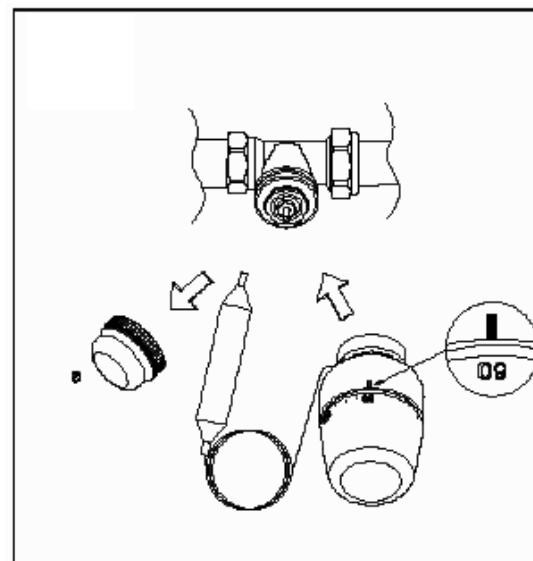
5.1. Термостатическая головка должна использоваться совместно с термостатическими клапанами, выполненными по стандарту HD 1215-2 Part2 и EN 215-1 part1 .
