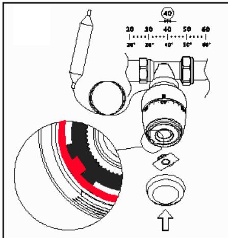
6.4. После указанных манипуляций следует установить на место фиксирующую планку «с» (до щелчка) и надеть крышку корпуса «б».
